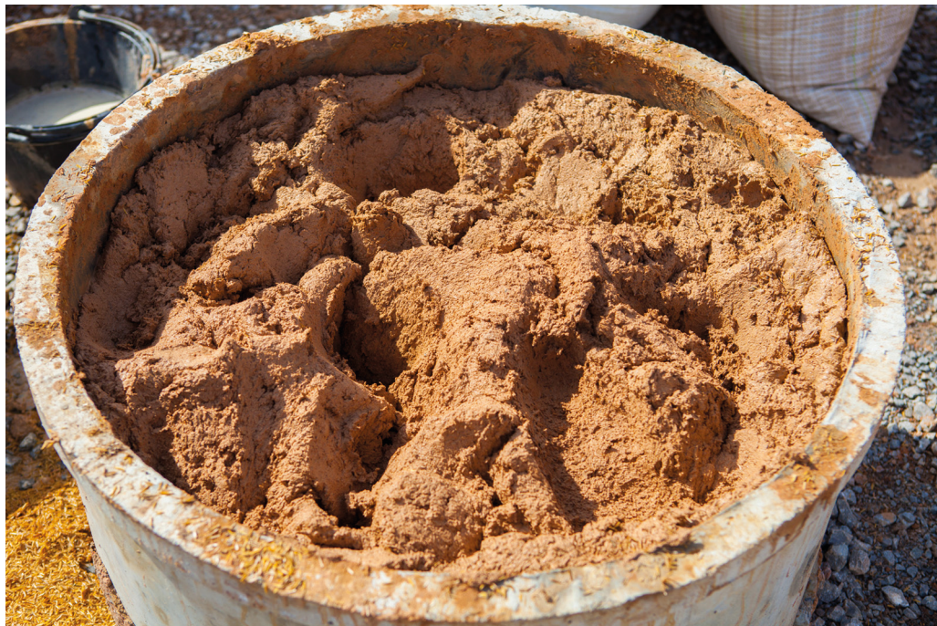
Der Lehmmörtel wartet auf seinen Einsatz
