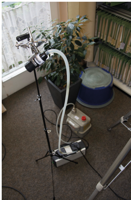
Staubprobenahme im Büroraum
