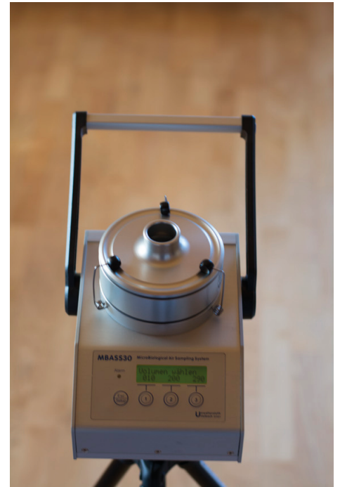
Ausrüstung für Luftprobennahme mit Nährböden und Partikelsammler
